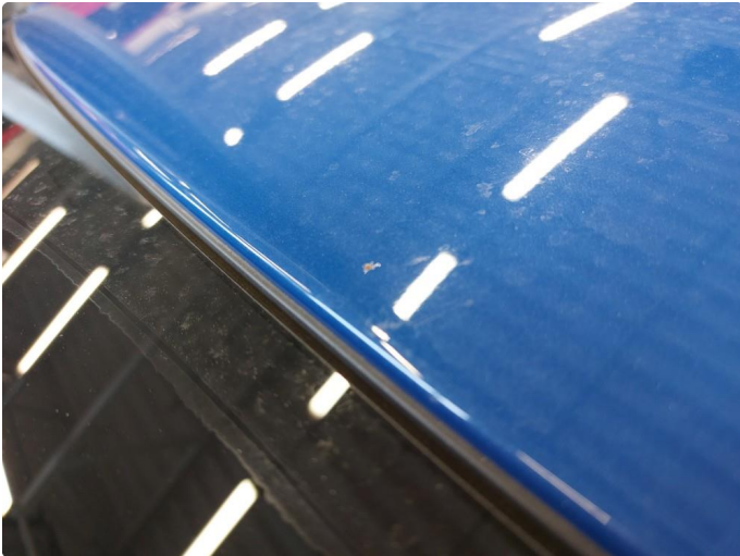
1.1 Steinsprut med rust
