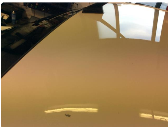
1.4 Sår i lakk på tak v side foran
